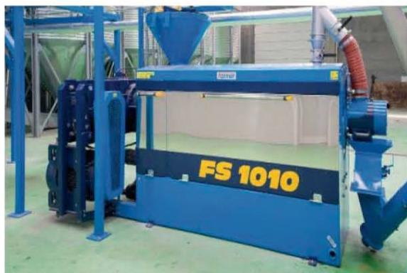
**Прессование горячим способом** – с предварительным подогревом масличных семян. Характерные черты: большой выход масла, более высокое содержание фосфолипидов, более энергоемкая технология.
