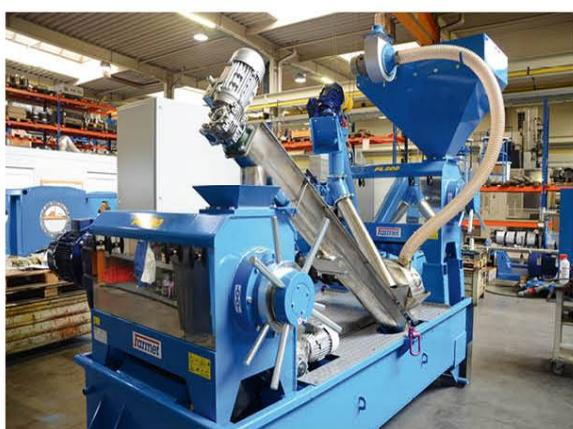
**Прессование с экструдерами** - процесс прессования, дополненный экструзией перед окончательным прессованием масличных (давление и температура). Характерные черты: большой выход масла, большая доля масла с низким содержанием фосфолипидов, более сложное технологическое оборудование, более энергоемкая технология, жмых высокого качества и с улучшенной пищевой ценностью.
